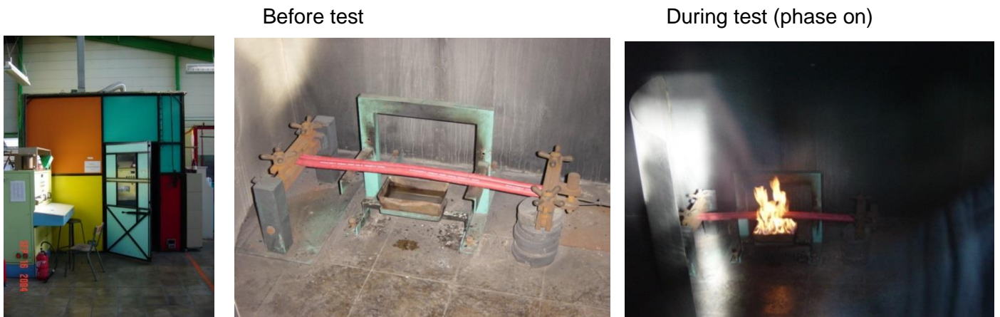
Figure 14 : EN ISO 61034-1 apparatus (courtesy from Nexans).
